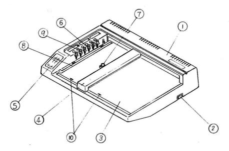
1) Case 2) Power switch 3) Recording table 4) Y slider 5) Operation panel 6) Pen stocker 7) Pen carriage 8) Paper holder 9) Pen stand 10) Paper guide
