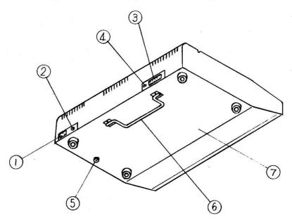
1) Inlet (Power cord) 2) Grounding terminal 3) Input/output connector 4) Select switch 5) Fuse holder 6) Stand 7) Base plate
